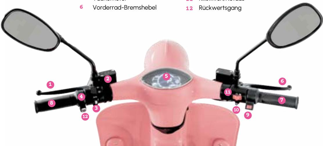
Das Display zeigt die Batteriespannung, die sich je nach Fahrstil anpasst. Hohe Belastung senkt die Spannung vorübergehend und lässt den Akku schneller entladen. Ein voller Akku liegt bei 70-71V, ein leerer bei 53-55V. Zur genauen Ladestandskontrolle orientieren Sie sich an der Volt-Anzeige, nicht nur am Ladebalken.
